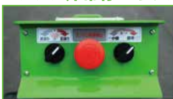
エンジン非常停止ボタン
